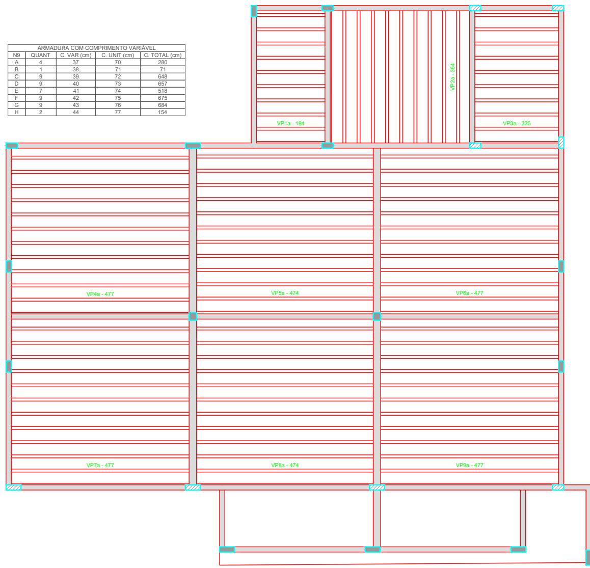
PLANTA DE VIGOTAS PRÉ-MOLDADAS Escala 1:100
